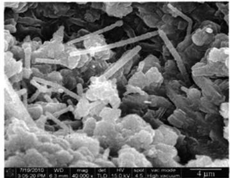
图9 镁碳砖中螺旋长管状纤维的形貌
