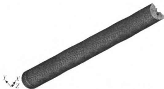
图 2 倒 T 形脱硫喷枪整体有限元模型
